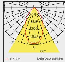
Downlight circular con tecnología LED para iluminación general, con difusor de policarbonato opal y reflector con acabado de aluminio especular con un alto grado de confort visual.
