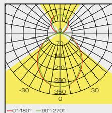
Luminaria de LED para sobreponer o suspender en losa o plafón. Con emisión de luz **directa e indirecta**. Fabricada en extrusión de aluminio con anodizado natural o con pintura poliéster en polvo, difusor de policarbonato opalino.
