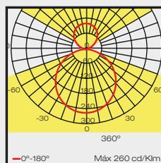
Luminaria lineal LED cuyo diseño esbelto, elegante, moderno y discreto, permite adaptarse a las diferentes necesidades del proyecto, para suspender, iluminación **directa e indirecta**. Fabricada en extrusión de aluminio con anodizado natural o con pintura poliéster en polvo, difusor de policarbonato opalino.
