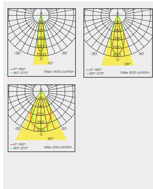
Luminaria para empotrar de alto confort visual con fuente de luz LED de 4 W de potencia, dirigible hasta 30° de inclinación, cuerpo fabricado en aluminio con recubrimientos de pintura de resina poliéster en polvo.
