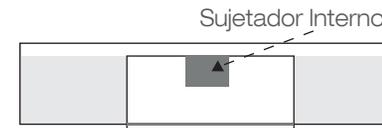
**4b** Colocar la tira dentro del perfil y ajustar con presión
