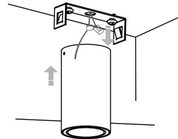
**4** Montar cuerpo principal sobre el soporte fijando con los opresores
