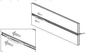
2 Colocar el perfil en el muro y asegurar con pijas
