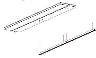
Realizar conexión eléctrica y colocar la tira comenzando por el lado de la alimentación antes de terminar de colocar la tira, se debe introducir primero la parte final para que quede debajo de la tapa
