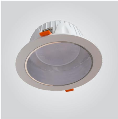
Downlight circular con tecnología LED para iluminación general, con difusor de policarbonato opal y reflector con acabado de aluminio especular con un alto grado de confort visual. Cuerpo en fundición de aluminio para su uso en interior. Incluye driver On/Off remoto.
